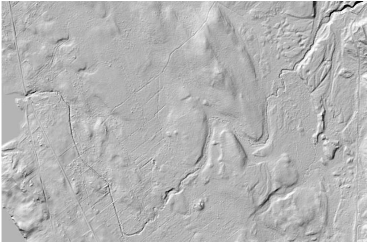
Figur 2. Markskuggningskarta över Brattbäcken där de övre delarna är tydligt meandrande och följer en naturlig sträckning medan de nedre delarna av bäcken är raka och tydligt kanaliserade. (Karta lånad från Skogsstyrelsen).
